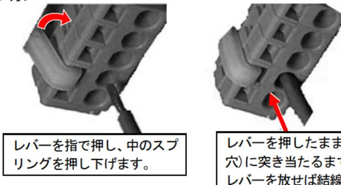
レバーを指で押し、中のスプリングを押し下げます。
