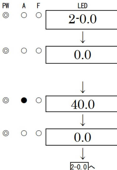
テストガスの導入を止め、指示値が下がったら、MENU/ESC キーを押してキャンセルし元に戻ります。
